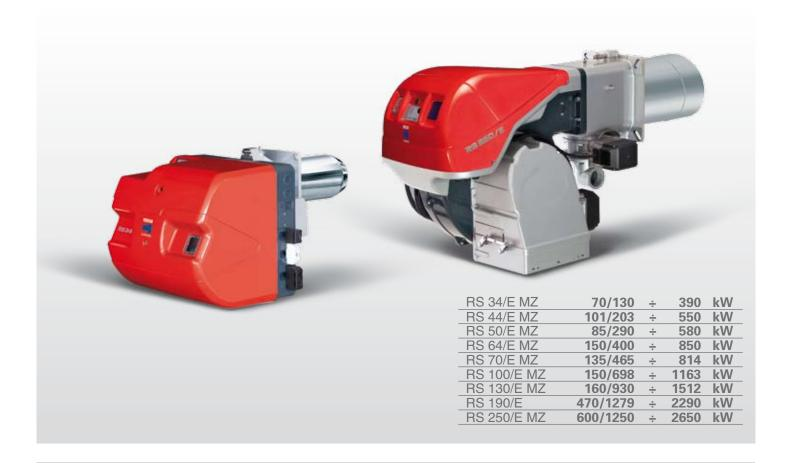
RS/E MZ系列燃烧器的出力范围为70-2650kW。此系列燃烧器是在利雅路燃烧器新型电子控制系统REC27基础上设计生产的,该系统通过一个独立的伺服马达控制空气-燃料比例以达到完美的出力控制并确保规则燃烧以及在全比例调节范围内燃烧器的安全运行。
